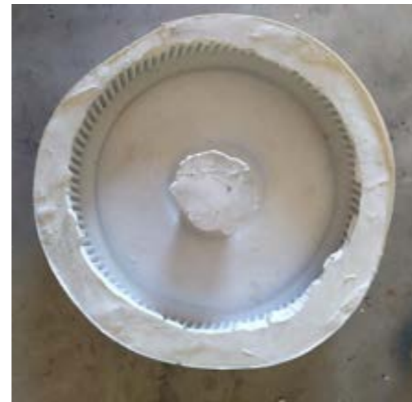
Antiguo molde de la misma pieza, hecho con el tubo de celofán. Imagen para compararlo con el nuevo molde echo con el tubo de hierro.
