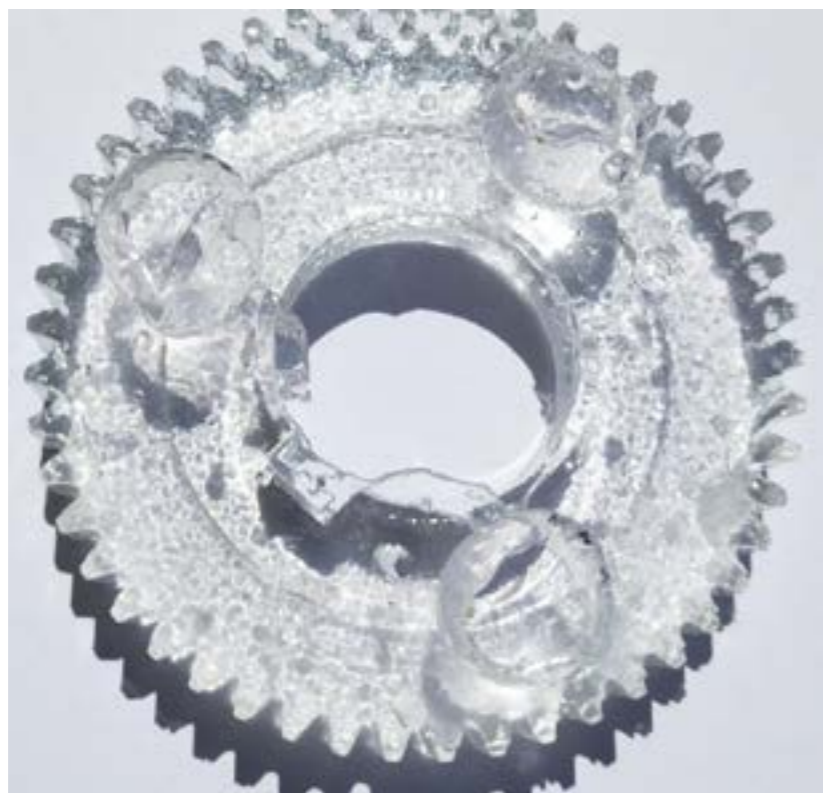
Sobre estas líneas, piezas de resina fruto de la nueva prueba con los moldes. De este modo, el pulido es mucho más sencillo, de controlar, pues no se trata de pulir una superficie entera, sino simplemente tres puntos sobresalientes.
