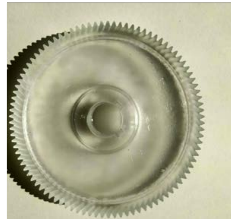
En esta imagen, la misma pieza por la parte que ha estado en contacto con la silicona. A causa del registro tan exacto que la silicona consigue de la pieza de hierro, se registra también en la pieza de resina la porosidad del hierro y sus imperfecciones, por lo que esta parte és menos transparente.
