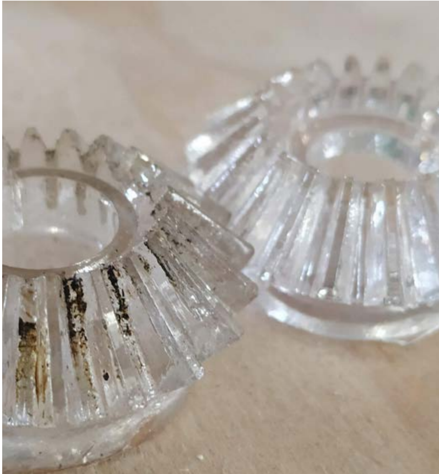
Sobre estas líneas, comparación de dos piezas de resina. La izquierda, sacada de un molde de una pieza de hierro que no había pasado por el proceso con el spray galvanizante. La pieza de la derecha, muestra los resultados del proceso.
