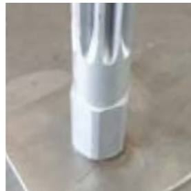
Una de las piezas sobre una base de hierro, unida mediante un punto de soldadura
