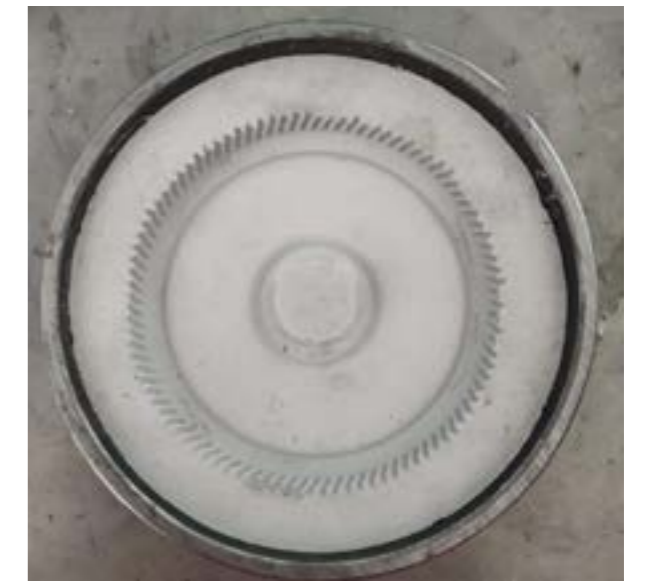
Imagen del resultado del molde echo con el tubo de hierro, que a demás sirve de encofrado.
