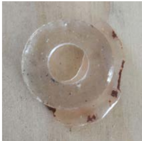
Pieza de resina correspondiente al molde anterior. Pordemos ver las manchas de barro y las rebabas.
