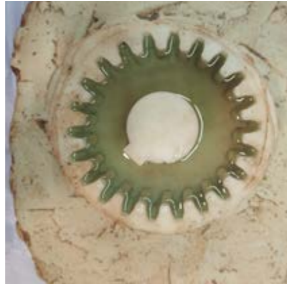
Molde de silicona al que se le acaba de verter la resina
