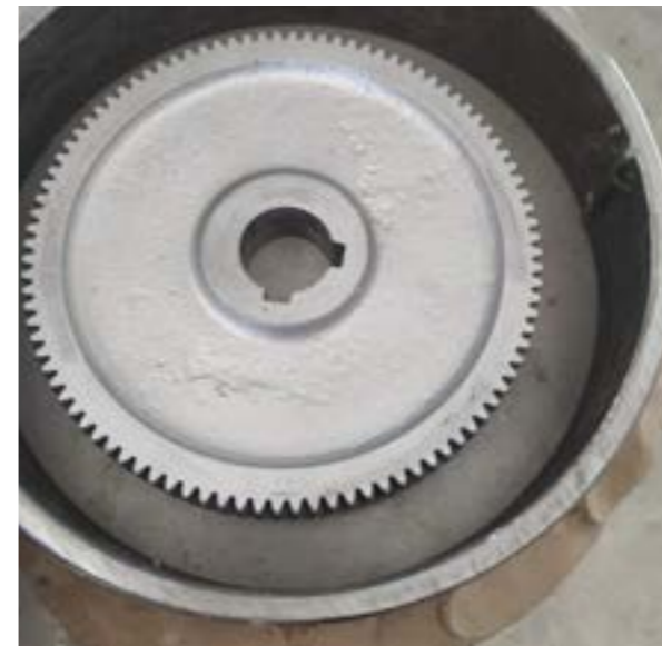
Pieza preparada con el tubo de hierro adiente a su tamaño cortado y sellado con la pastelina. Preparado para verter la silicona
