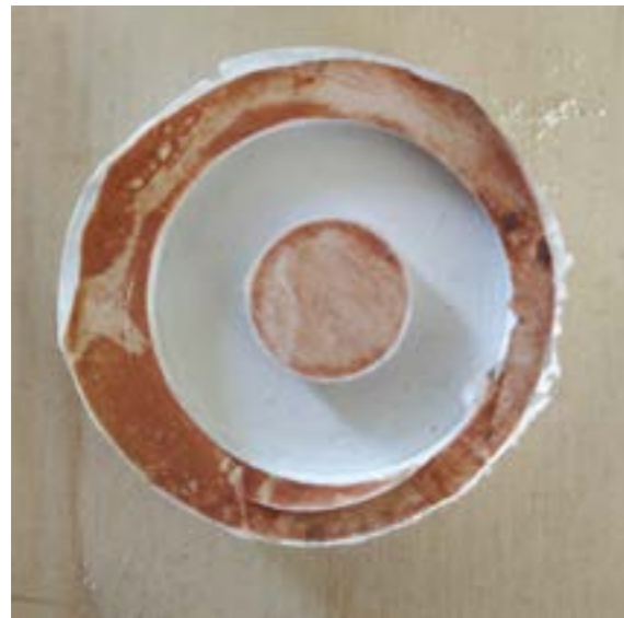
Molde de silicona realizado sobre cama de arcilla
