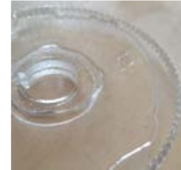
Detalle de la pieza con rebabas en la superficie.
