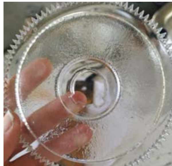
Resultado de pieza a partir del molde del referente galvanizado, que ha tenido la necesidad de ser lijada.
