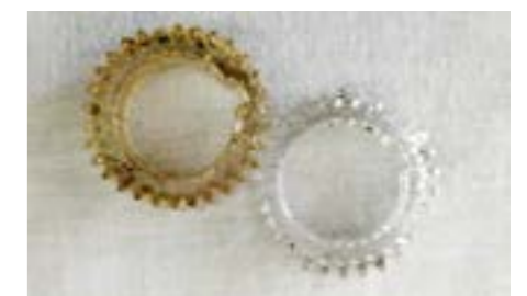
Arandela amarillenta por culpa de un exceso de catalizador, junto a una con la medida justa.
