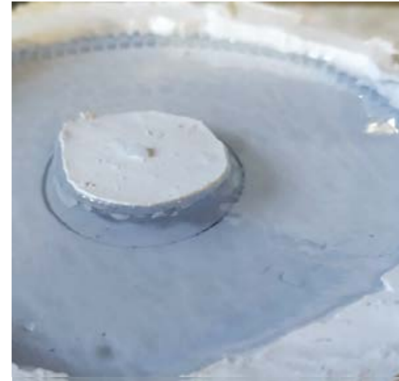
Plano detalle de la parte de la pieza de resina que no ha estado en contacto con la silicona. El efecto es mucho más brillante y pulido.
