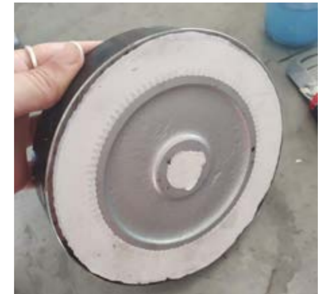
Molde con la silicona preparada para ser desmoldada
