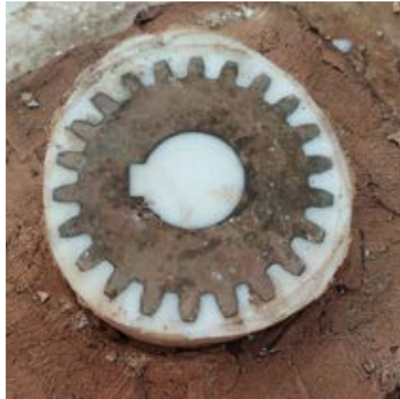
Molde en base de arcilla, con la silicona ya fraguada.
