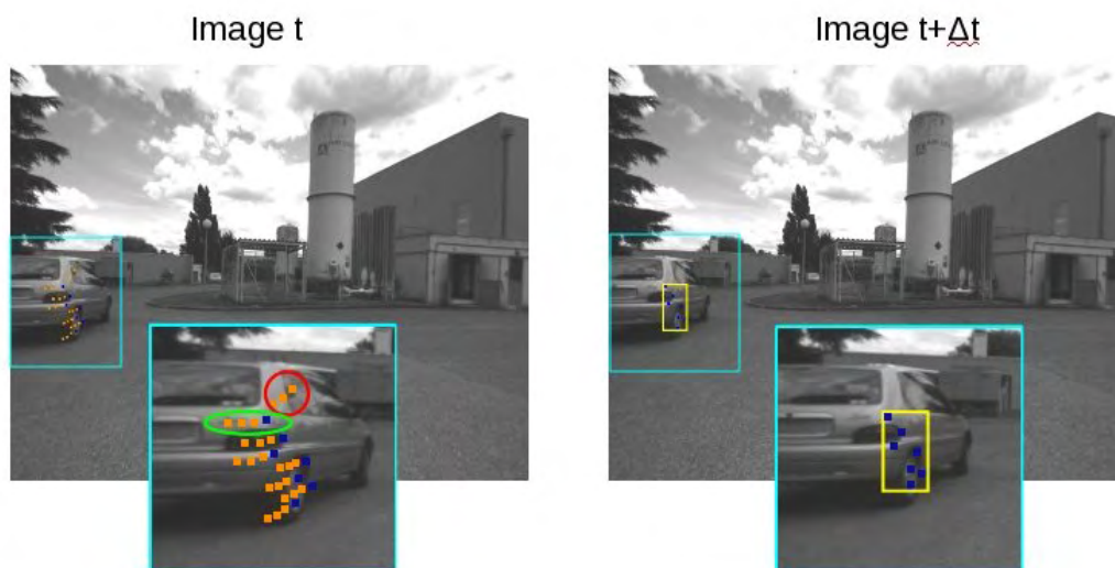
FIGURE 4.1 – Initialisation du modèle de l'objet. À gauche, le groupe de points identifié comme un objet dynamique : les points en orange désignent les positions lors du temps de pistage, tandis que les points en bleu représentent les positions sur l'image t . À droite dans le rectangle jaune, seuls les points en bleu de l'image t sont retenus pour générer le modèle de l'objet et le suivre à partir de l'image t + \Delta t .
