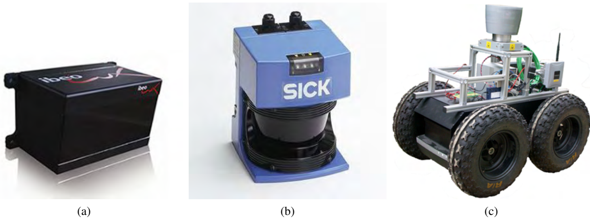
FIGURE 2.2 – a) Télémètre laser de haute résolution de la compagnie Ibeo. b) Capteur LMS200 de Sick Inc. en Allemagne ; ce capteur est fréquemment utilisé sur les robots pour la navigation à vitesse modérée. Il est intégré sur notre démonstrateur Dala (figure 5.10). c) Capteur Velodyne monté sur notre démonstrateur Mana .
