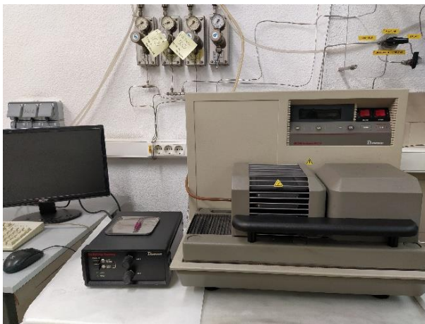
Figura 2.9. Termobalanza SDT 2960 Simultaneous DSC-TGA de la marca TA Instruments disponible en los laboratorios del grupo MCMA-UA.
