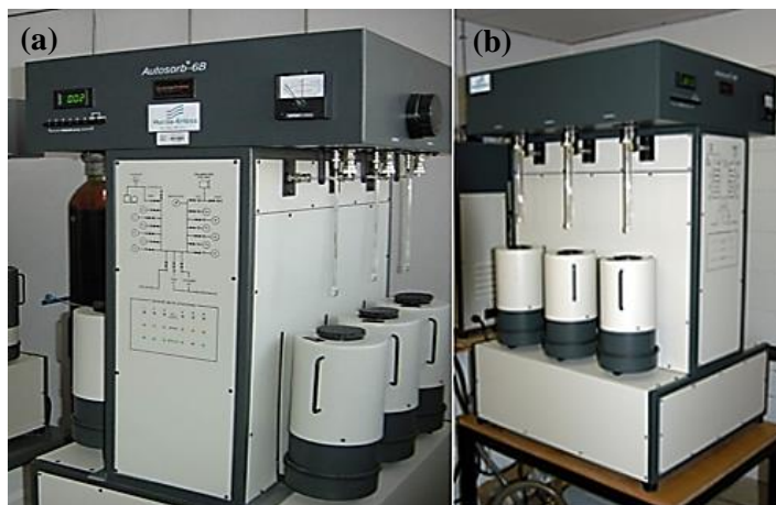
Figura 2.1. Equipos de adsorción física de gases: (a) AUTOSORB-6B disponible en los laboratorios del grupo MCMA-UA y (b) AUTOSORB-6 disponible en los SSTI-UA.
