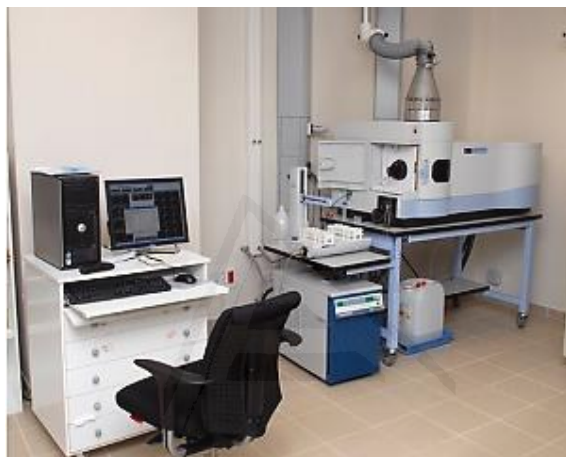
Figura 2.4. Espectrofotómetro de emisión con plasma de acoplamiento inductivo Perkin Elmer, disponible en los SSTI-UA.
