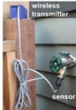
FIGURE 3.6 – Détection des changements de pression dans le projet Hydrosense [FLC + 09].
