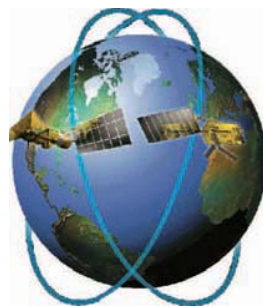
FIG. 1.1 – Schéma de la trajectoire orbitale des satellites défilants
