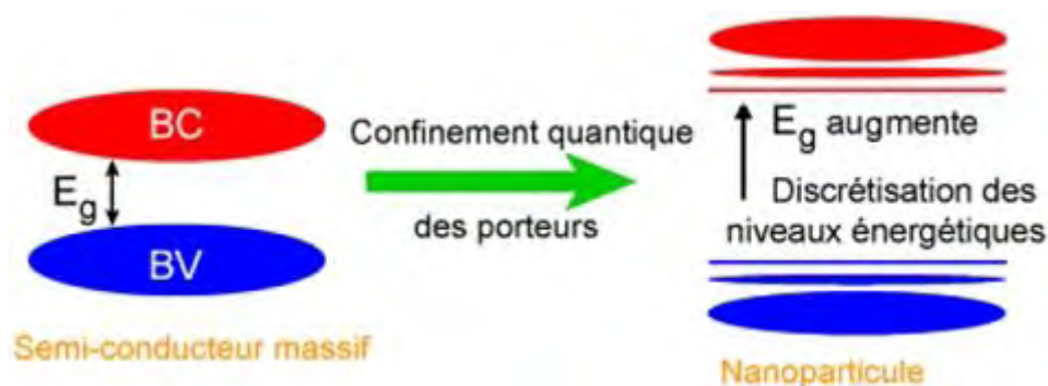
Figure 13. Représentation schématique de l'évolution de la bande interdite en fonction de la taille des particules.
