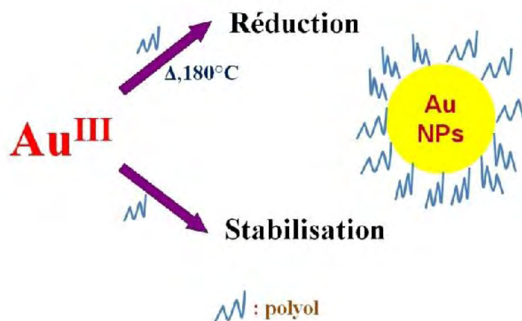
Figure 8. Mécanisme de formation des NPs d'or en milieu polyol.
