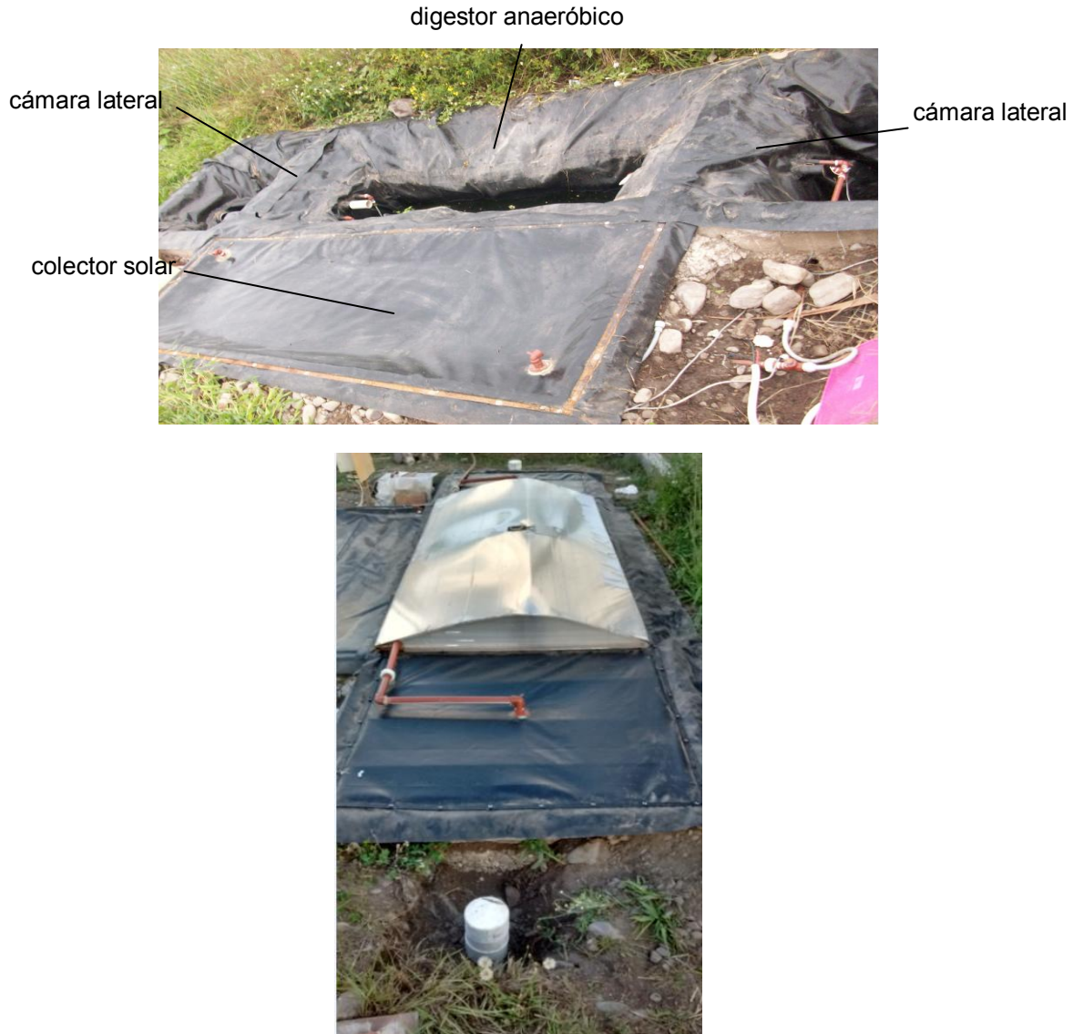
Figura 1. Imagen superior: digestor anaeróbico, cámaras laterales y el colector solar. Imagen inferior: invernadero
