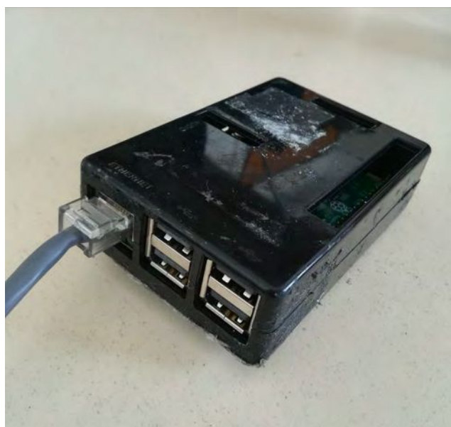
Figura 6.21: Raspberry Pi 3 B usada para comunicar el dron con el Cloud.
