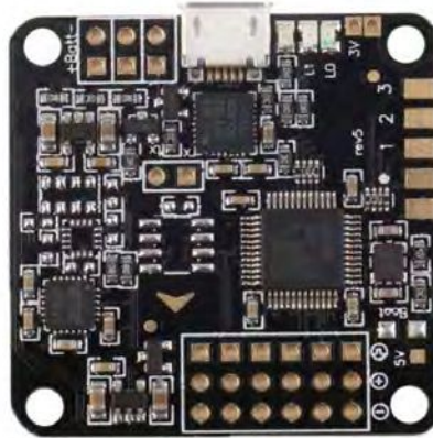
Figura 3.12: Placa controladora de dron.
