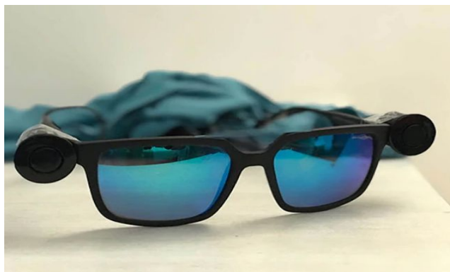
Figura 4: SiVeO son unos anteojos de asistencia para personas con ceguera o discapacidad visual.
