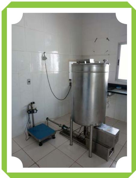
**Figura 3.** Tanque de armazenamento de polpa.
