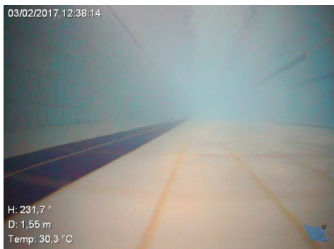
(a) Imagem captada pelo ROV Pro 4 da Videoray no fundo de uma piscina, sendo perceptível o efeito de perda de visibilidade por efeito de backscattering .
