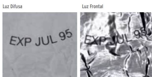
Figura 2.15: Comparação entre luz difusa e luz frontal [17].
