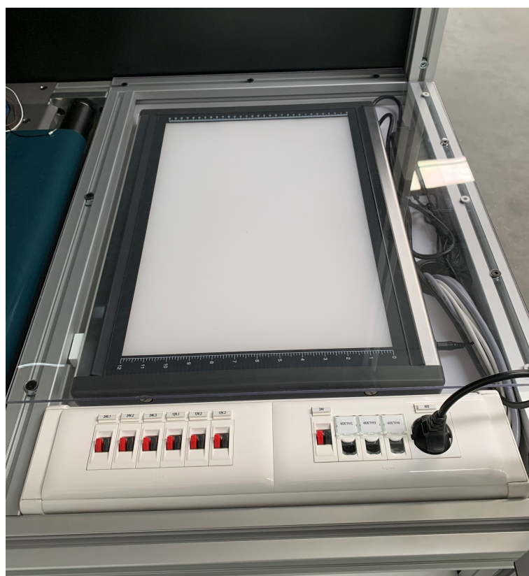
Figura D.9: Backlight e calha de saídas elétricas.
