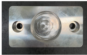
(c) Suporte para o rolamento do rolo movido pela tela.
