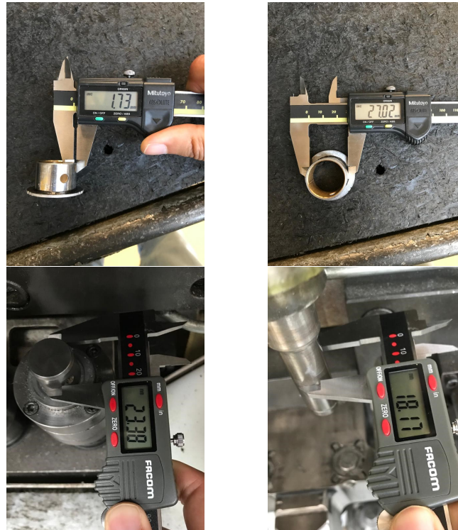
Figura 5.16: Medições de componentes e da estrutura da prensa
