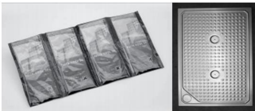
Figura 12- Exemplos de macro encapsulamento: esquerda, através de bolsas, e direita, recipiente metálico. (Mehling e Cabeza, 2008)
