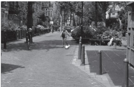
Figura 14. Exemplo de uma zona 'woonerf' (Seco et al, 2008).
