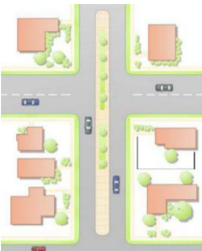
Figura 23. Esquema de um separador central numa interseção (InIR).
