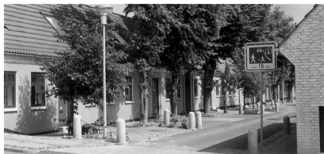
Figura 16. Exemplo de uma zona 'woonerf' e respetiva sinalização (Seco et al, 2008).
