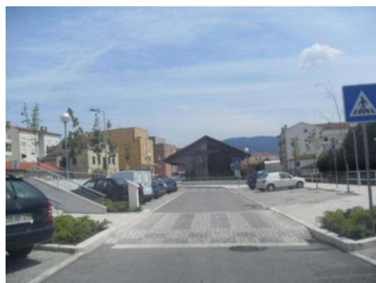
Figura 38. Exemplo de uma passadeira elevada (Miranda do Corvo). (InIR)
