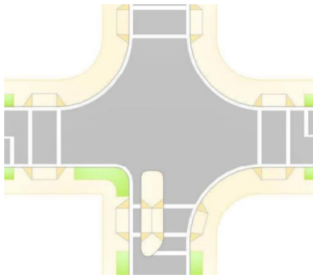
Figura 21. Esquema encerramento parcial de via (InIR).
