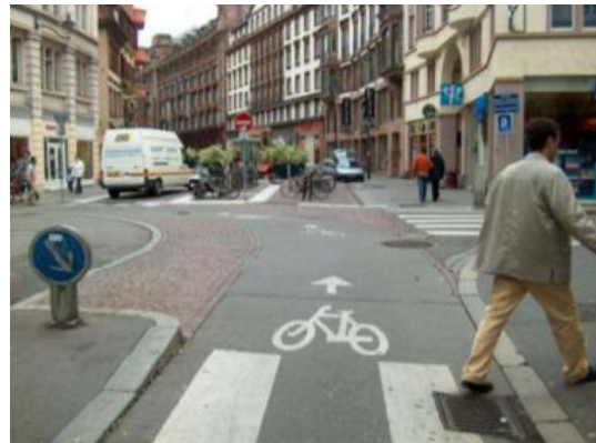
Figura 42. Exemplo de pavimentos diferenciados para os diferentes utilizadores (Estrasburgo). (InIR)
