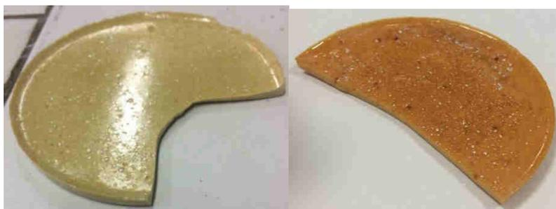
Figure 15 : Échantillons de [TETM/DDS+10%HT] : cuit avec une montée en température à 10°C/min puis isotherme à 220°C pendant 30 minutes à gauche, et cuit à 260°C pendant 30 minutes à droite.
