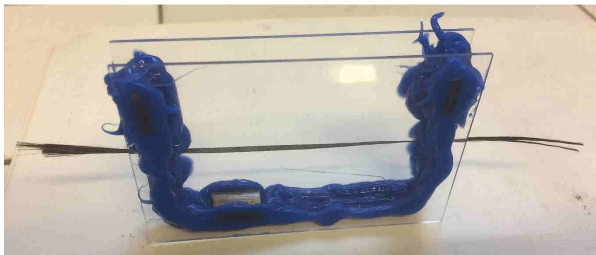
Figure 25 : Une cuve d'observation du bullage au voisinage d'une fibre.
