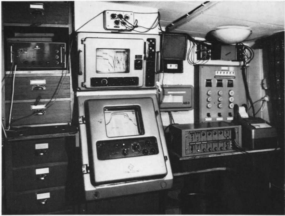
Abb. 13. Schelfrandlot-Anlage im Brückenlotraum von F. S. „Meteor“. Links oben: Kalibrierungsgeber, Mitte: Registriergeräte (unten Mutter-, oben Tochterschreiber), rechts: Digitalanzeigergerät mit Schreiber.
