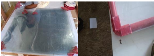
Gambar 5. Proses perekatan velcro pada permukaan mika rigid dan pipa PVC
