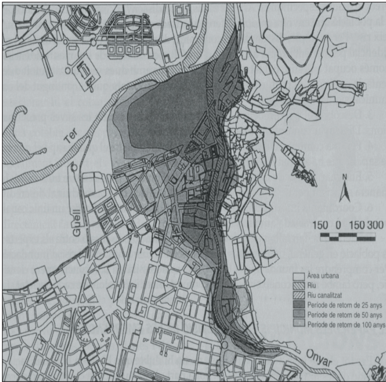
Figura 2. Mapa del área inundable por el río Onyar para avenidas de diferentes periodos de retorno. Tomado de Ribas y col. (1997). Fuente: Ajuntament de Girona. Pla especial d'inundacions, 1993-1994.
