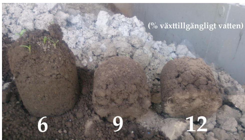
Bild 2 Cylindrar från olika vattenhalter efter avslutat tredje försök
