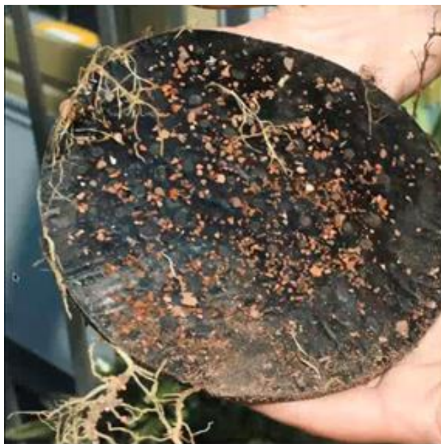
Obr. 18: Ochranná fólie proti prorůstání kořínků
