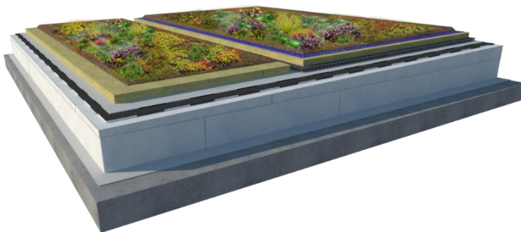
Obr. 2: Ukázka extenzivní vegetační střechy
