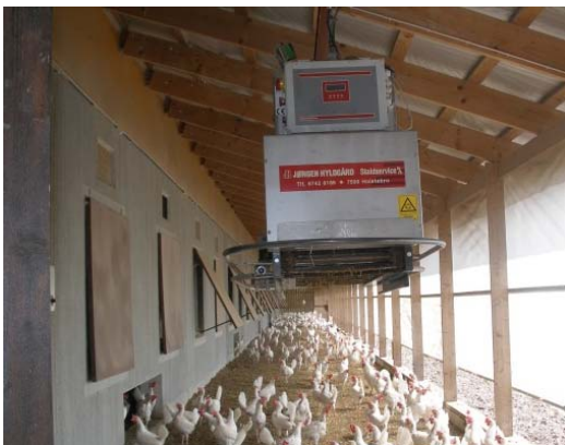
Figur 9. Rälshängd foderspridare i vinterträdgården Figur 10. Rastgården
