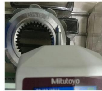
Figura 3.9 Posições de medição (a) Flanco de dente; (b) Topo de dente; (c) Face oposta.
