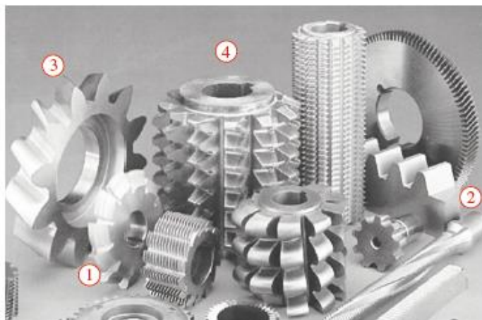
Figura 2.1 Ferramentas para corte de engrenagens: 1 – cortador de fresa, 2 – cortador de cremalheira, 3 – cortador de geração, 4 – caracol.
