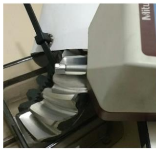
Figura 3.9 Posições de medição (a) Flanco de dente; (b) Topo de dente; (c) Face oposta.
