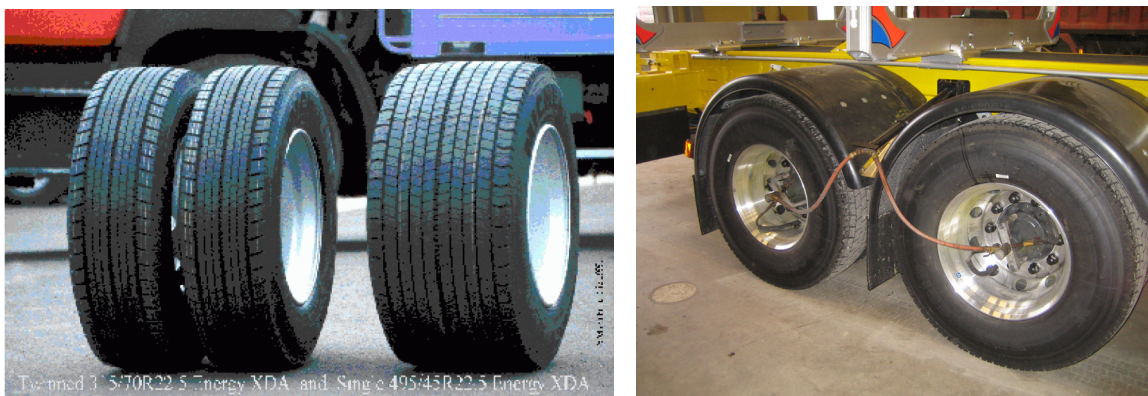
Figur 1. Fotot till vänster visar det traditionella dubbelmontaget och ett Super Singel hjul (Foto Michelin). Fotot till höger visar hjul utrustade med CTI (Foto Granlund Lb-Teknik).
