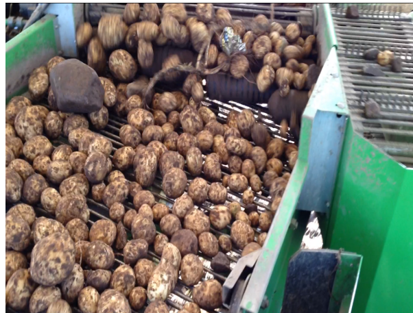
Bild 3. Denna bild är tagen uppe på upptagarens rensband och här syns även en stor sten och lite småsten. Det kommer dock inte så mycket sten i det lilla bandet till höger där sten skall ha sorterats bort och åka ut på backen.
