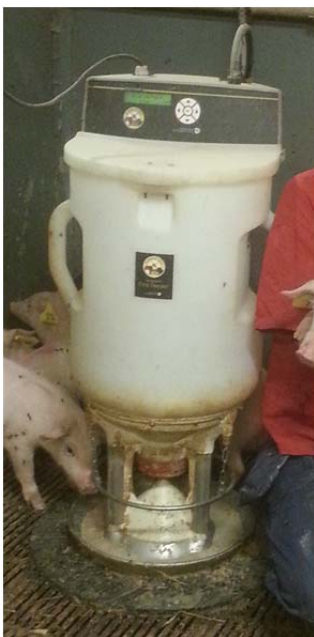
Figur 1. Utfodringsautomat av märket First Feeder.
