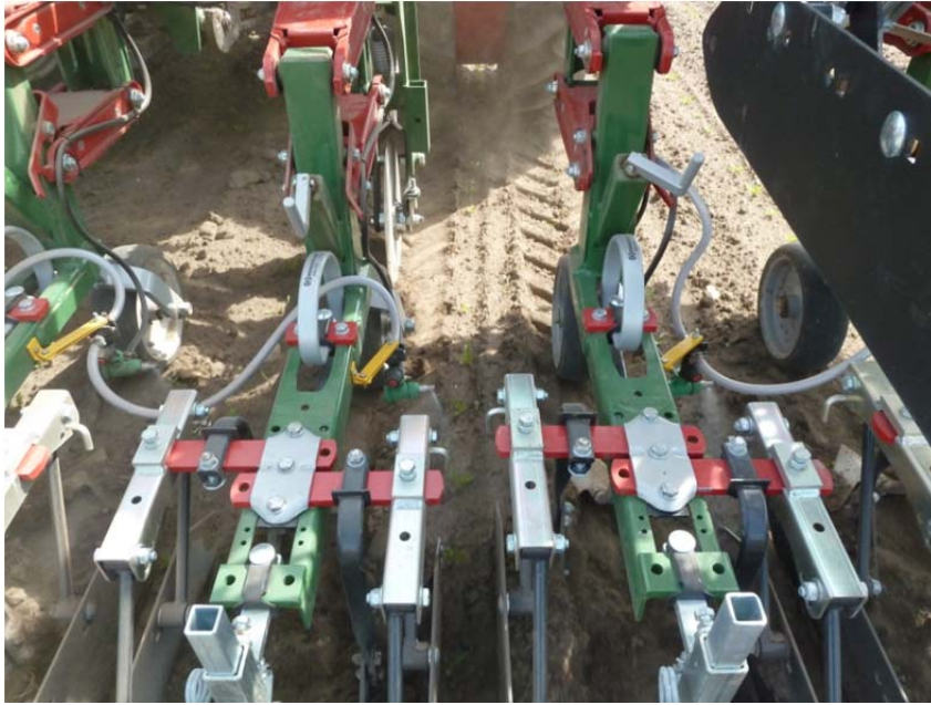
Figur 5. AirTech luftassisterat sprutmunstycke på ett reglerbart fästjärn i vardera aggregat över raden.
