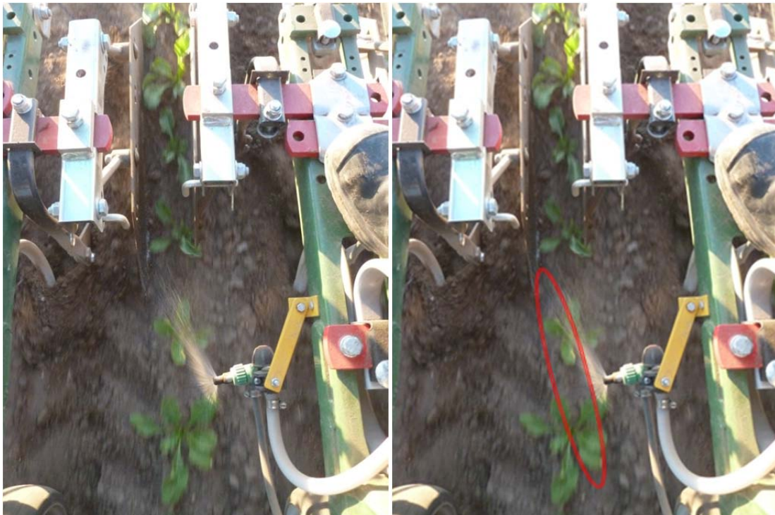
Figur 6. Sprutmunstycke vinklat för att uppnå 12 cm bandbred.
