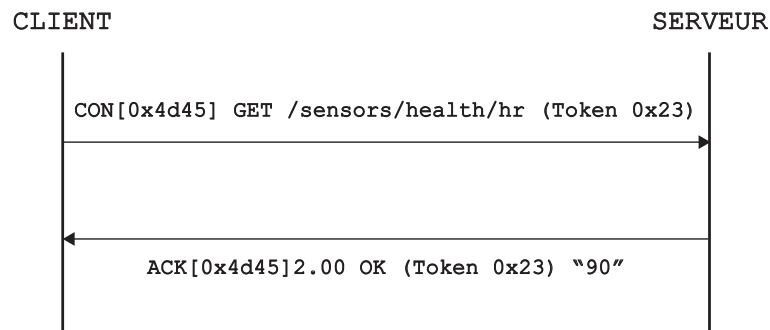
Figure 3.7 : Exemple d'un échange de messages entre un client et un serveur dans une architecture REST basée sur CoAP qui permet de récupérer la valeur d'un capteur cardiaque.
