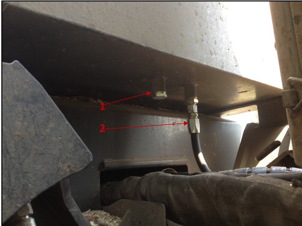
Figur 22. Undersida vattentank. 1: Extra anslutning. 2: Anslutning mellan vattentank och mixtank.
