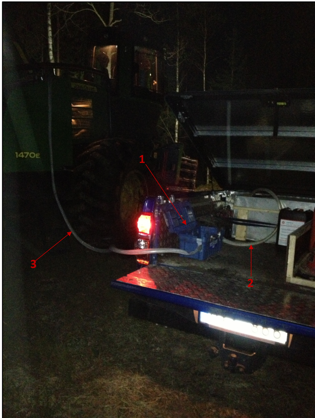
Figur 10. Påfyllnad av kompletteringstank och orginaltank vid slut på arbetsdag. 1: Portabel vattenpump. 2:1 tums vattenslang mellan tank på arbetsbil och vattenpump. 3:1 tums vattenslang mellan vattenpump och kompletteringstank.
