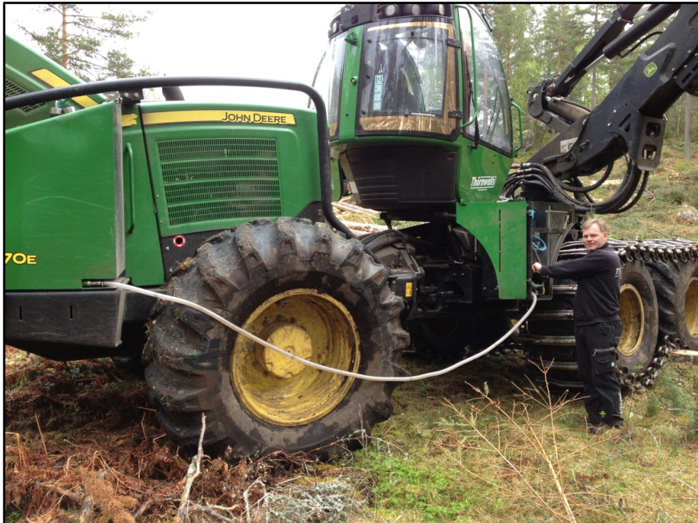
Figur 9. Påfyllnad av vatten från kompletteringstank till orginaltank vid skiftbyte. Vattnet fylls över med pump.
