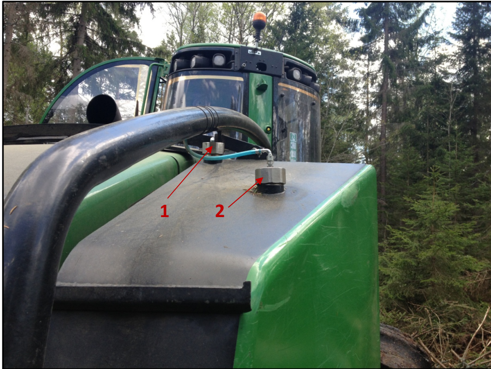
Figur 6. 1: Påfyllnad kompletteringstank. 2: Påfyllnad extra dieseltank.
