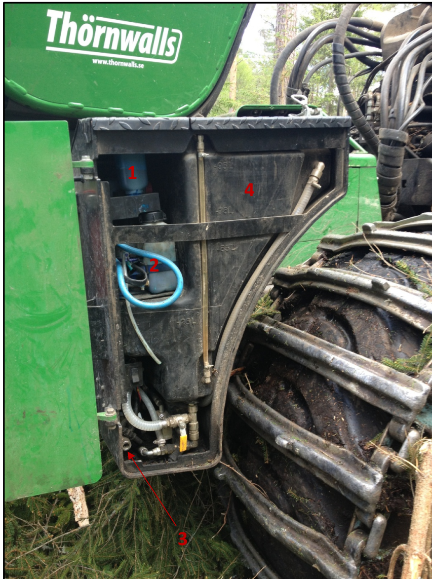
Figur 2. Bilden visar delar av den originalmonterade stubbehandlingsutrustningen. 1: Behållare för stubbehandlingspreparat. 2: Mixtank. 3: Snabbkoppling för påfyllning av vatten till vattentank. 4: Vattentank cirka 100 liter.
