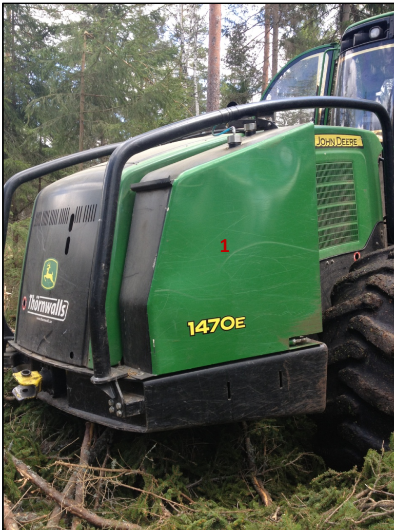
Figur 4. 1: Kompletteringstank för vatten 180 liter. Den extra dieseltanken är placerad inuti kompletteringstanken.
