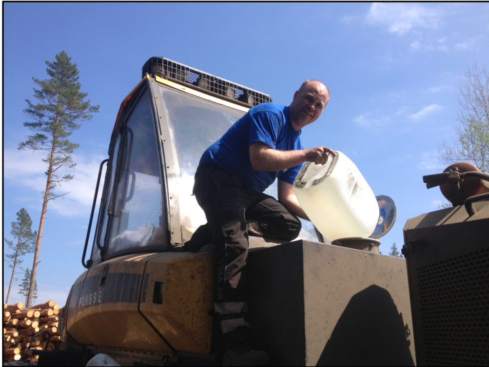
Figur 24. Påfyllnad av vattentank vid slut på arbetsdagen.
