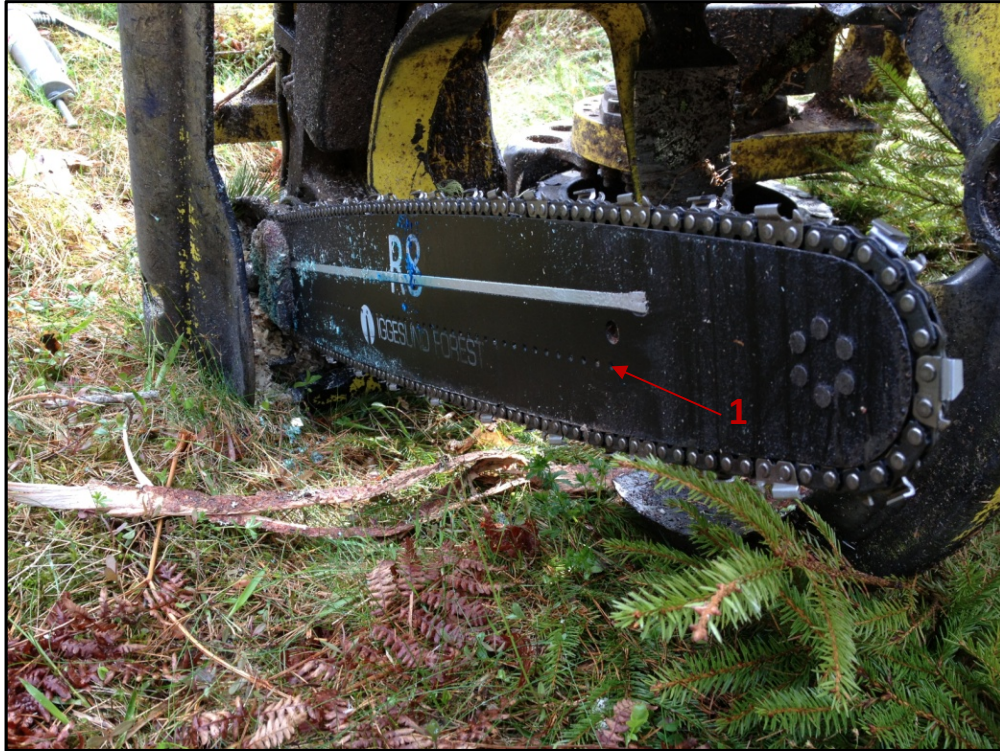
Figur 3. Svärd för stubbehandling. 1: Utstansade hål som borrar upp innan användning.
