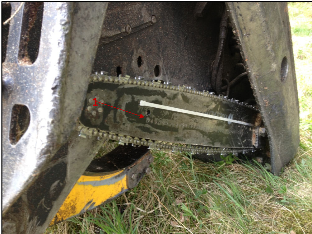
Figur 19. Svärd för stubbehandling. 1: Utstansade hål som borras upp innan användning.
