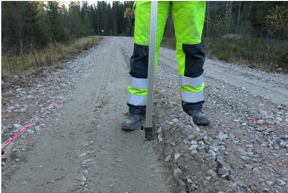
Figur 20. Kombination av typ 0 och 1 spårbildning. Figure 20. Combination of type 0 and 1 rutting.
