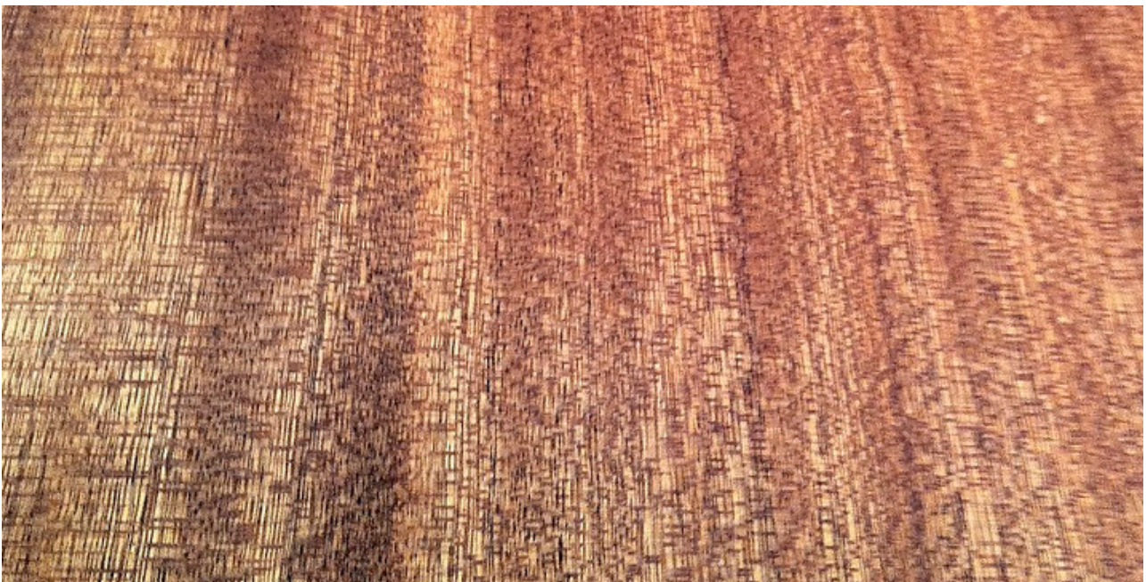
Fig. 5, Sapele tropiskt träslag med skiktvis växlande fiberriktning.
