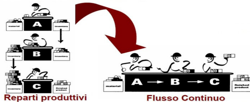
Figura 5: Da una produzione a lotti al one-piece flow
