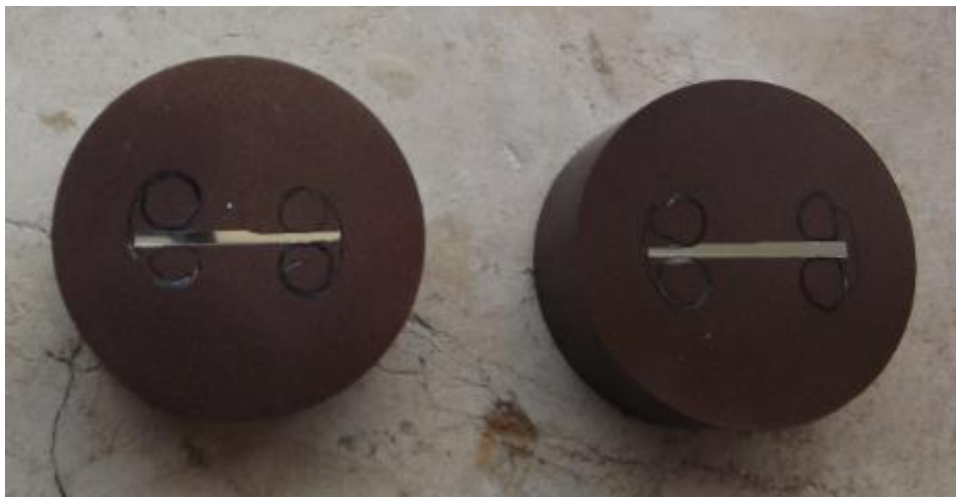
Figura 3.26 - Foto di due provini per le prove di microdurezza.
