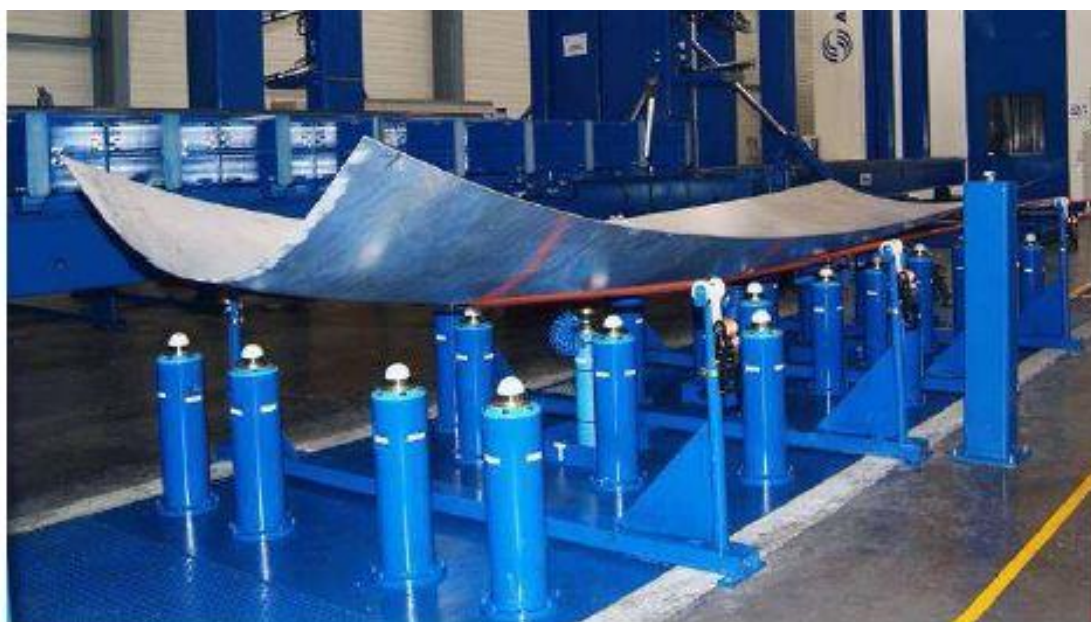
Figura 3.7 - Attrezzo riconfigurabile sul quale viene adagiato il pannello.
