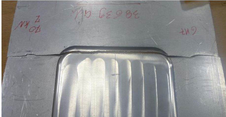
Figura 4.20 – Modalità di cedimento consueta per un provino con tasca ottenuta mediante fresatura meccanica
