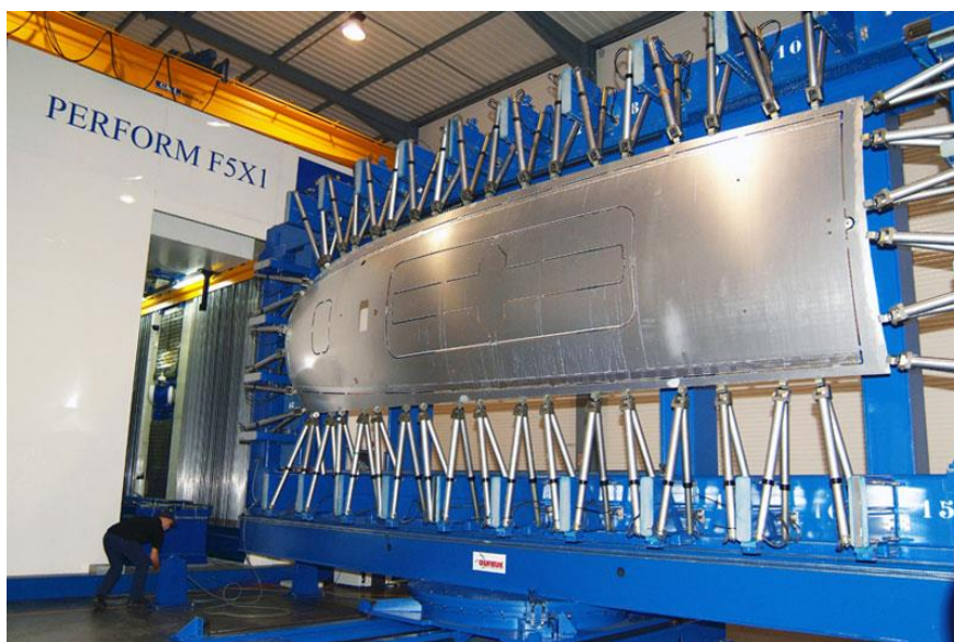
Figura 3.9 - Ribaltamento in verticale del quadro e ingresso nell'area di lavoro.
