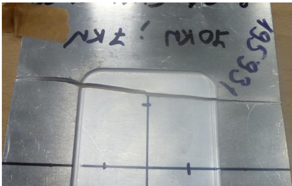
Figura 4.22 – Modalità di cedimento con innesco nel raggio di raccordo fra gli spigoli della tasca di un provino con tasca ottenuta mediante fresatura chimica
