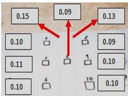
Figura 4.11 - Valori della Ra medi: a) per profili ortogonali alle fibre; b) per profili paralleli alla direzione delle fibre.
