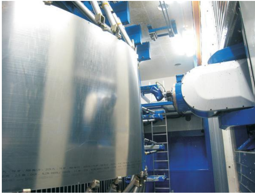
Figura 3.10 - Scannerizzazione del pannello nell'area di lavoro.
