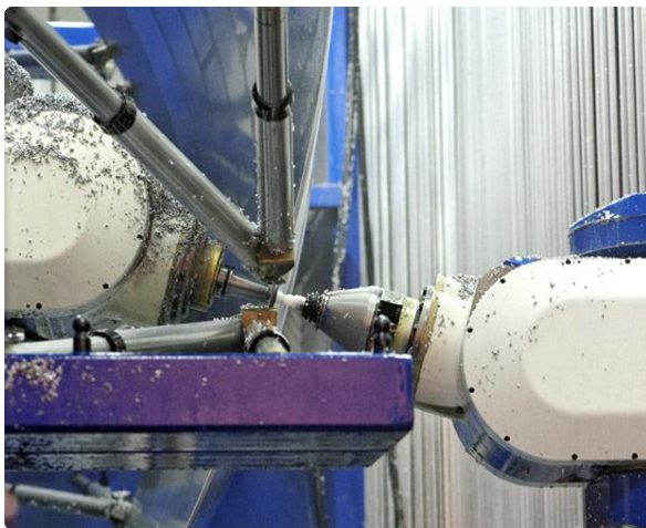
Figura 3.11 - Fresatura a specchio del pannello nell'area di lavoro.
