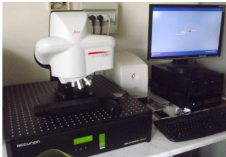
Figura 3.19 - Leica DCM – 3D con unità di scansione e sottostante supporto di isolamento inerziale.
