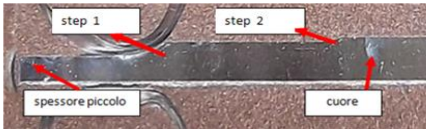
Figura 3.27 - Aree interessate dalla prova di microdurezza sulla porzione di sezione a gradino.
