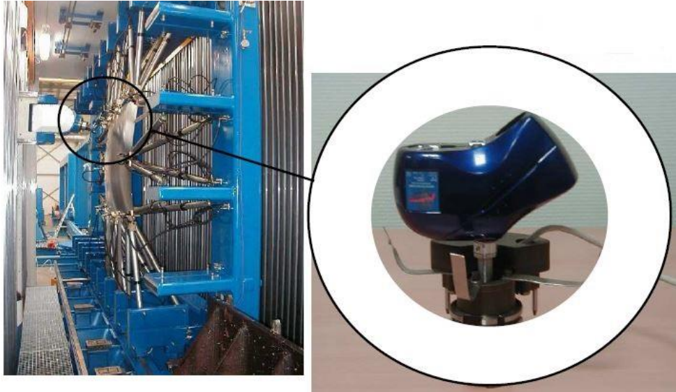
Figura 2.23 - Sensore ottico per la digitalizzazione del pannello.
