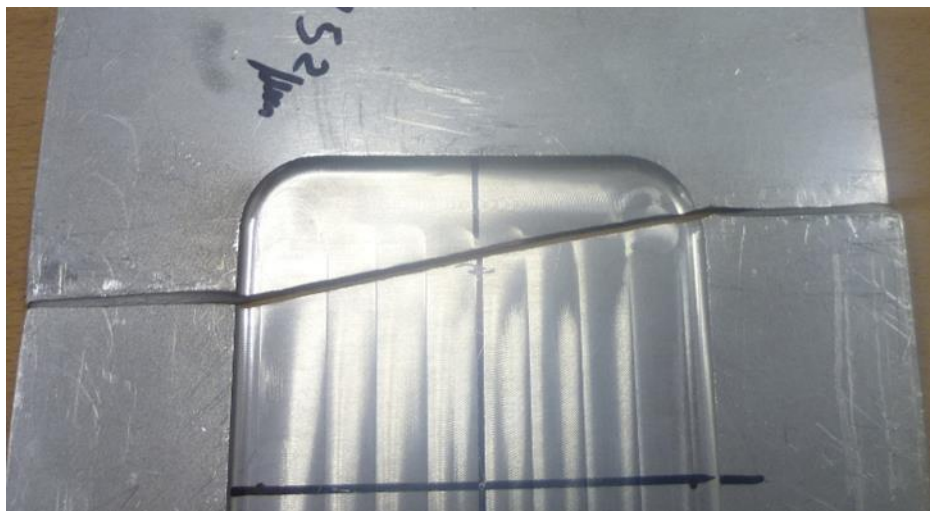
Figura 4.21 – Modalità di cedimento con innesco nel raggio di raccordo fra gli spigoli della tasca di un provino con tasca ottenuta mediante fresatura meccanica
