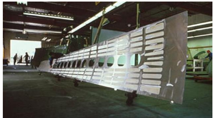
Figura 2.6 – a) Cad di una lamiera su cui sono indicate le zone dove saranno praticate le tasche di alleggerimento, b) Pannello di un aereo sagomato per fresatura chimica.
