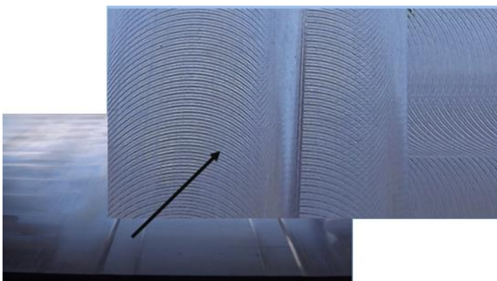
Figura 4.2 - Macrografia della superficie fresata meccanicamente.
