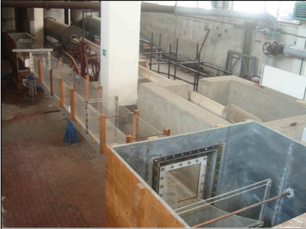
Fig.2.7 Veduta dall'alto del canale sperimentale, del cassone di alimentazione e dell'invito sagomato
