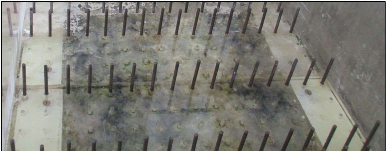
Fig.2.20 Distribuzione dei cilindri di tipo "aligned". I cilindretti sono distribuiti su una maglia rettangolare di dimensioni 2.5cmx10.0cm
