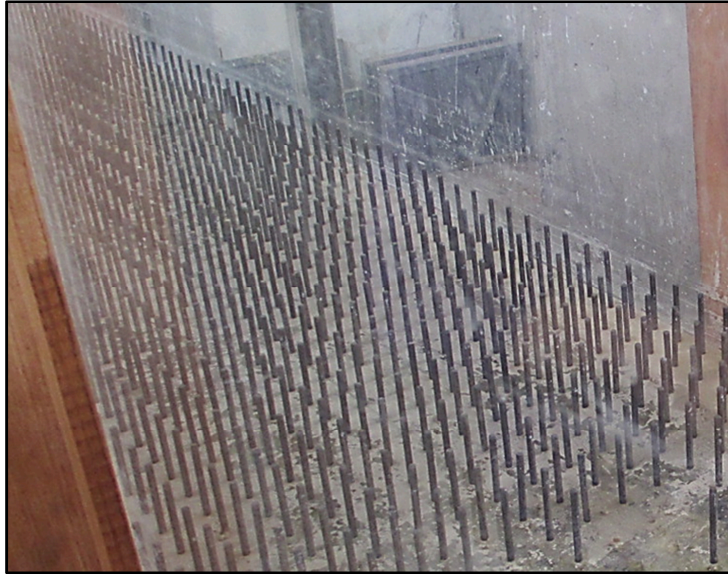
Fig.2.14 Rappresentazione di distribuzione dei cilindri alti 4.5cm su maglia quadrata di dimensioni 2.5cm 2
