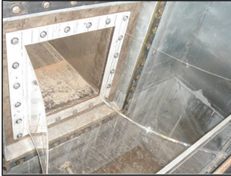
Fig.2.5 Invito sagomato a "ramo di iperbole" presente nel cassone di alimentazione
