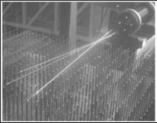
Fig.2.1 Modello di vegetazione mediante cilindri di metallo (Poggi et al., 2004)
