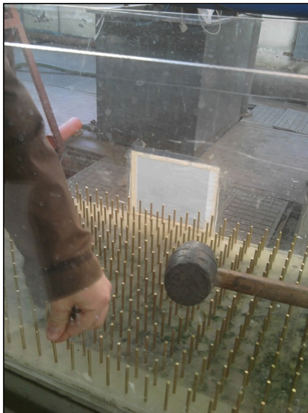
Fig.2.11 Immissione dei cilindri di metallo all'interno delle piastre forate
