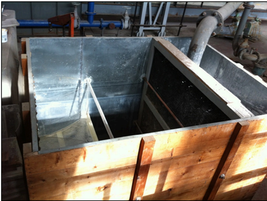
Fig.2.4 Cassone di alimentazione del canale sperimentale
