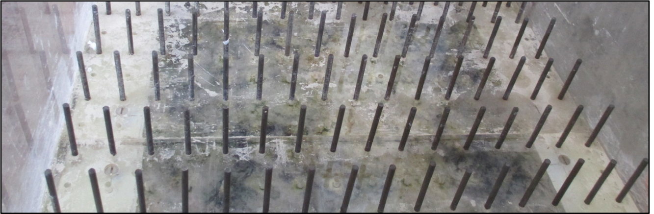
Fig.2.19 Distribuzione dei cilindri di tipo "aligned". I cilindretti sono distribuiti su una maglia rettangolare di dimensioni 2.5cmx5.0cm
