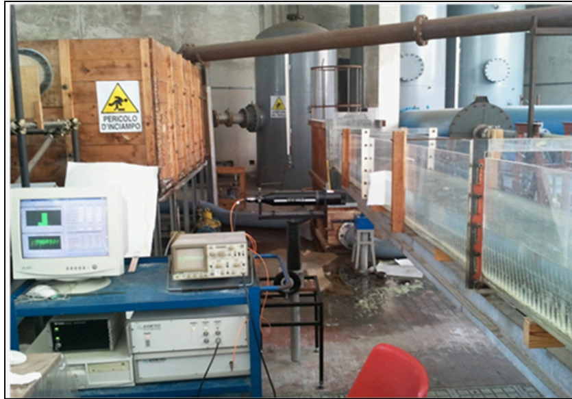
Fig.5.10 Rappresentazione sistema LDA in funzione nel canale sperimentale presso il Dicea-Dipartimento Ingegneria Civile, Edile ed Ambientale-Univ. “Federico II”
