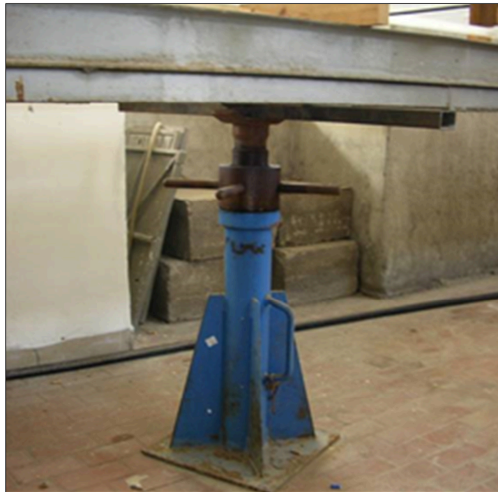
Fig.2.6 Particolare dei martinetti presenti lungo il canale sperimentale; la loro installazione ha consentito di variare la pendenza S del canale a seconda delle necessità di ricerca
