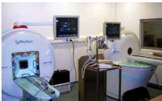
8. ábra | Modern preklinikai képalkotó laboratórium kis laboratóriumi állatok vizsgálatára alkalmas PET/MRI, valamint SPECT/CT kamerákkal
