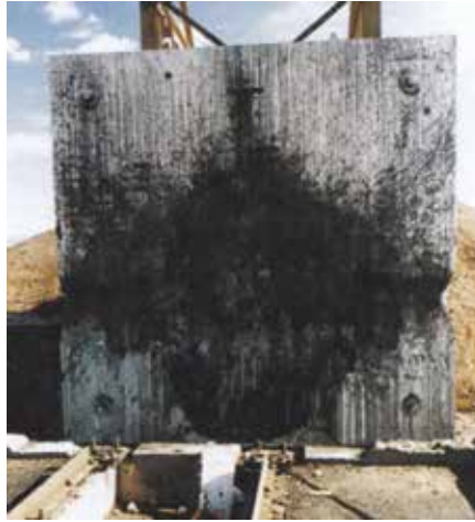
5. ábra. A vasbeton céltárgy a Phantom gép ütközése után [4]
