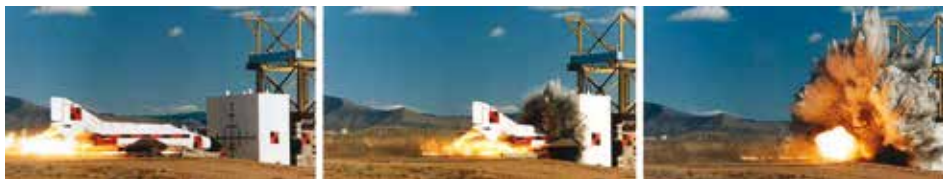
4. ábra. Phantom F4 vadászgép ütközése vasbeton falba [4]
