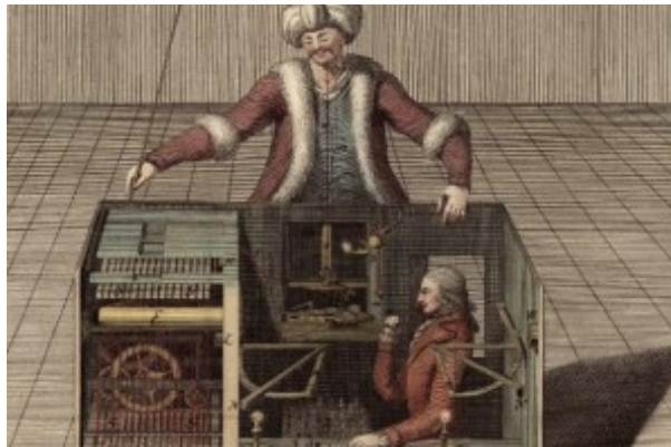
Kempelen sakkozógépének feltételezett felépítése
