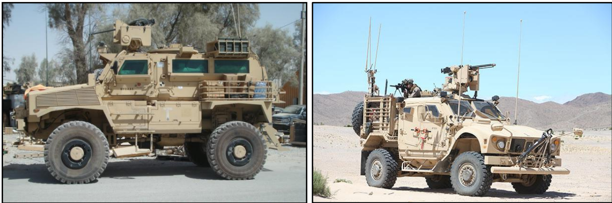
4. ábra: RG-31 típusú biztosító járművek távvezérelt fegyverrendszerrel 20
