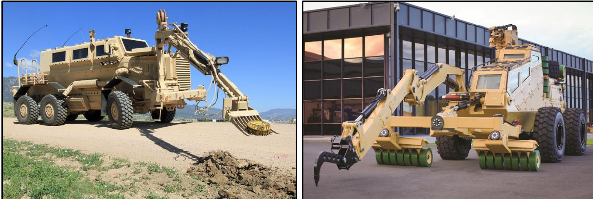
3. ábra: Buffalo és PEROCC típusú járművek manipulátorkarral felszerelve 18
