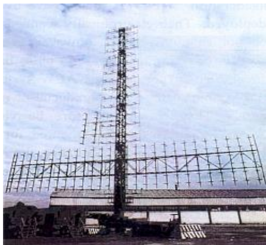
8. ábra: Földi telepítésű VHF/UHF monostatikus radar (P-18)
