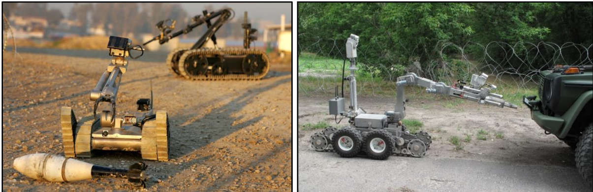
7. ábra: Tűzszerész robotok munkavégzés közben Andros F-6 típusú nehéz tűzszerész robot 23
