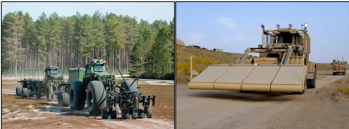
2. ábra: Souvim és Husky típusú járművek terepen, útfelderítés közben 17
