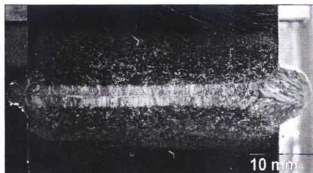
3. ábra: 1.4462 számjelű duplex acél 40 mm vastagságú lemez hegesztési varratának keresztmetszeti szövetképe [4]
