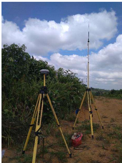
Gambar 1. Pengukuran GPS Geodetik untuk titik Base
