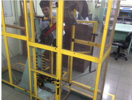
Gambar 3.11 Alat uji impact
