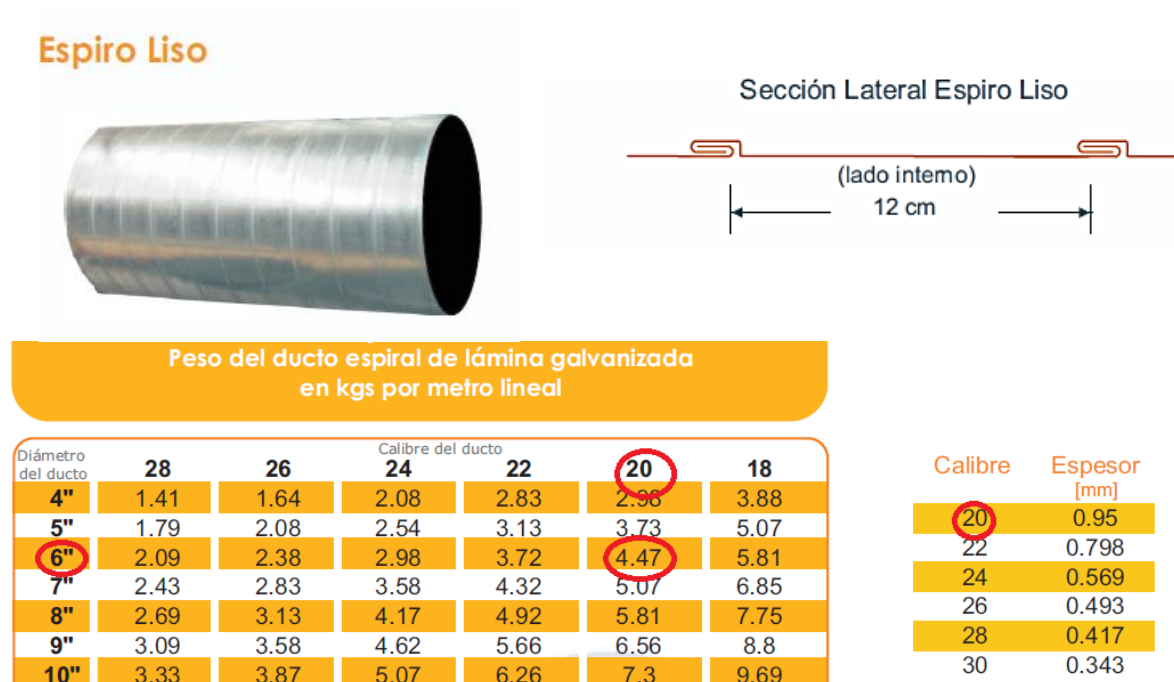
Figura 8. Detalle Ducto circular de acero galvanizado engargolado en espiral liso
