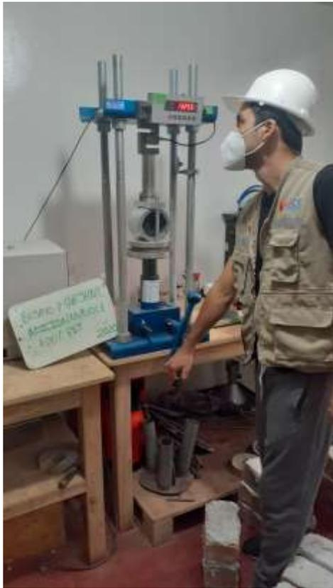
Foto nº 17 Ensayo Marshall (compresión)
