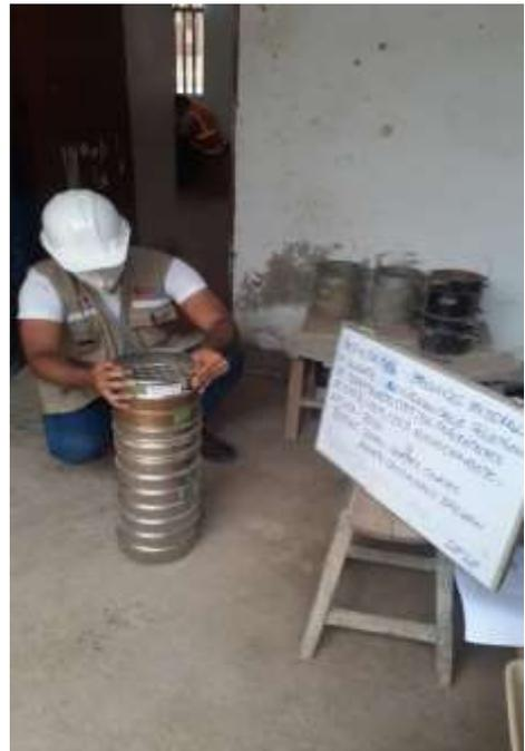
Foto nº 2 Ensayo - Análisis Granulométrico
