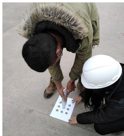
Figura 24 Disparo con el esclerómetro
