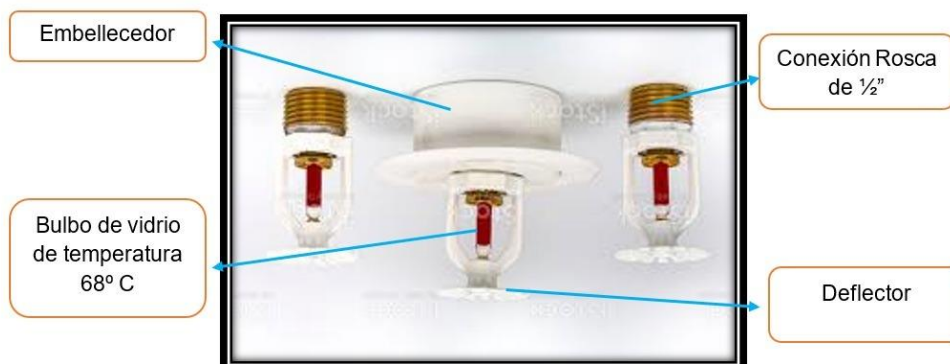
Figura N°09 Rociador colgantes de 68°C, bulbo color rojo
