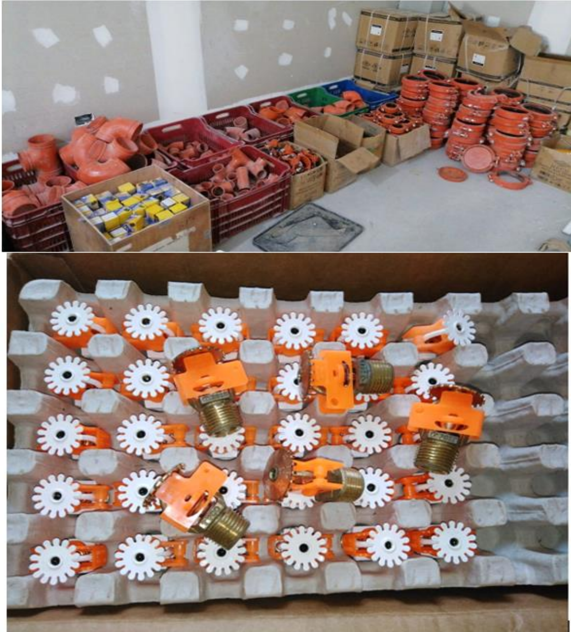
Figura N°18 Accesorios y rociadores
