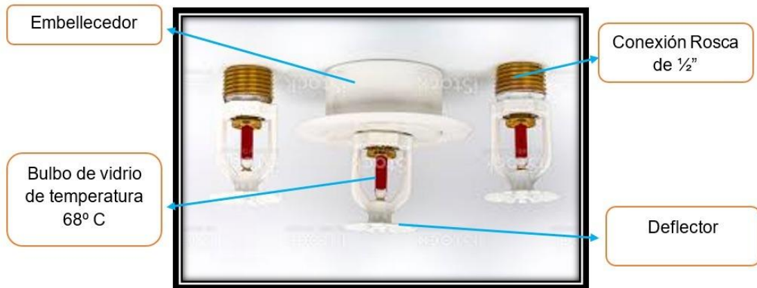
Figura N°02 Rociadores y sus partes
