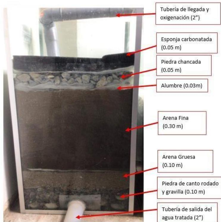
Figura 5: Prototipo de filtro lento de arena con carbón vegetal y sus dimensiones por capa de material
