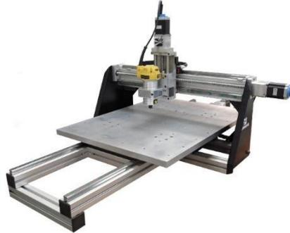
*Figura 17: Router CNC con mesa de trabajo móvil y transmisión de movimiento con tornillo de potencia y correa con polea*
