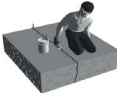
Gráfica 65. Instalación de puertos de entrada
