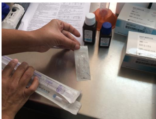
Figura 9. Cubetas o celdas desechables para mediciones espectrofotométricas con una base cuadrangular de 1 x 1 cm. Los reactivos para realizar el análisis también se muestran en la imagen (frascos ámbar de tapa blanca y azul).
