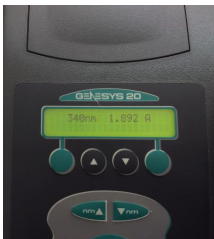
Figura 13. Lectura de la absorbancia de la muestra (se muestra un ejemplo). Se obtuvieron tres mediciones por muestra.
