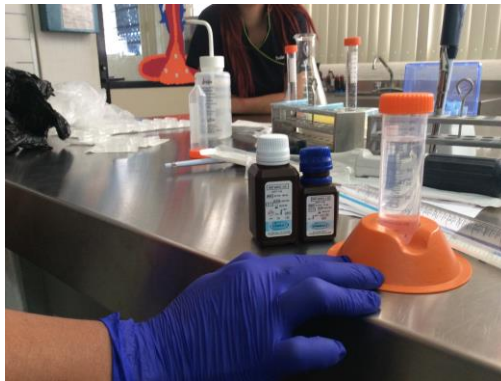
Figura 11. Preparación de 30 ml de reactivo de trabajo RT. Se incubó durante 1 minuto a temperatura ambiente. Frasco con tapa blanca corresponde al reactivo 1. Frasco con tapa azul corresponde al reactivo 2.
