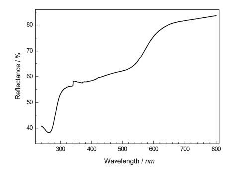
Figure S3. Diffuse reflectance UV/Vis spectrum of  $Y_{26}Ba_6[Si_{22}O_{19}N_{36}]O_{16}$ :Eu<sup>2+</sup>.
